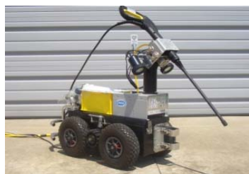
JAEA-2号 (屋内観察・除染ロボット)
